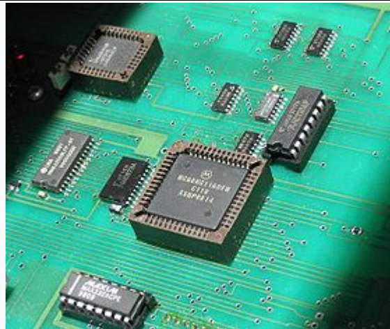
Microcontrolador Motorola 68HC11 y chips de soporte que podrían constituir el hardware de un equipo electrónico industrial.
