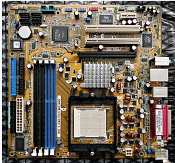
Placa base de una computadora, formato \mu ATX.
